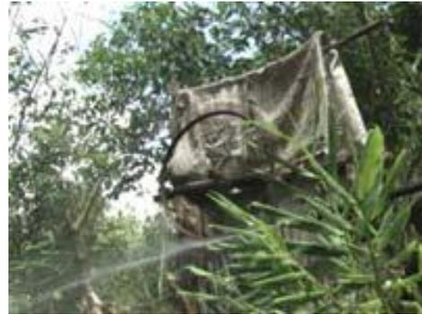
Die „Cuchufleta“ ist eine Erfindung eines kubanischen Ingenieurs, der in den Bergen der Sierra Maestra im Osten von Kuba lebt. Es ist ein Mikro-Strom-Generator, der mehrere Häuser in einer abgelegenen Gegend der Sierra Maestra mit Strom versorgt.
